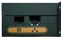
▲ HD-521P 側面(左)-RJ-11 及 RJ-45 直通端子口
